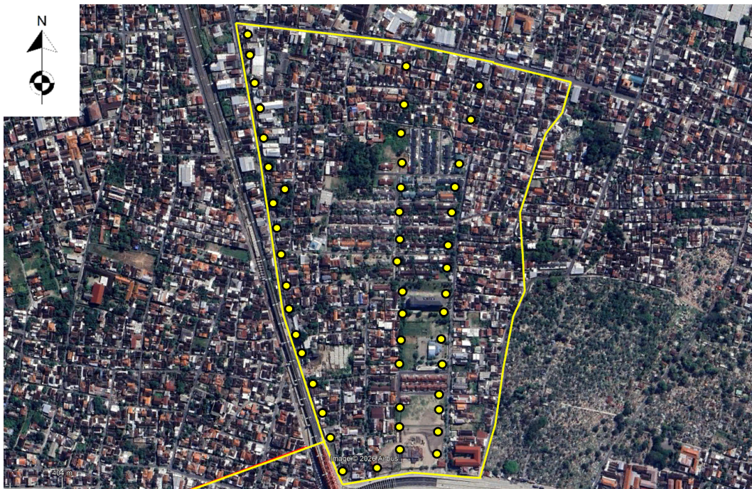
Gambar 3. Penempatan Sumur Resapan
